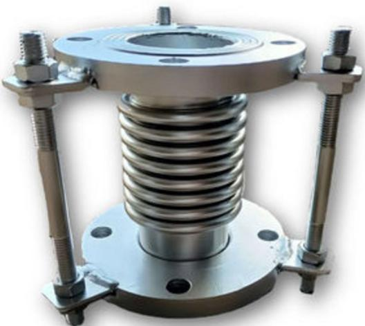
Компенсатор сильфонный серии BELLOW EXPANSION JOINT — это высокотехнологичное решение для защиты трубопроводных систем от теплового расширения, вибраций и шума. Изделие предназначено для использования в условиях высоких температур (от -10°C до +300°C) и давлений (до PN40), что делает его незаменимым в системах отопления, водоснабжения, паровых и промышленных сетях.
