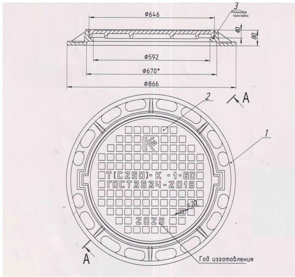
Люк чугунный тяжелый Т(С250)-1-60 h-80 производится на заводе из серого чугуна и подходит для установки на автостоянках, тротуарах и проезжей части городских парков.
