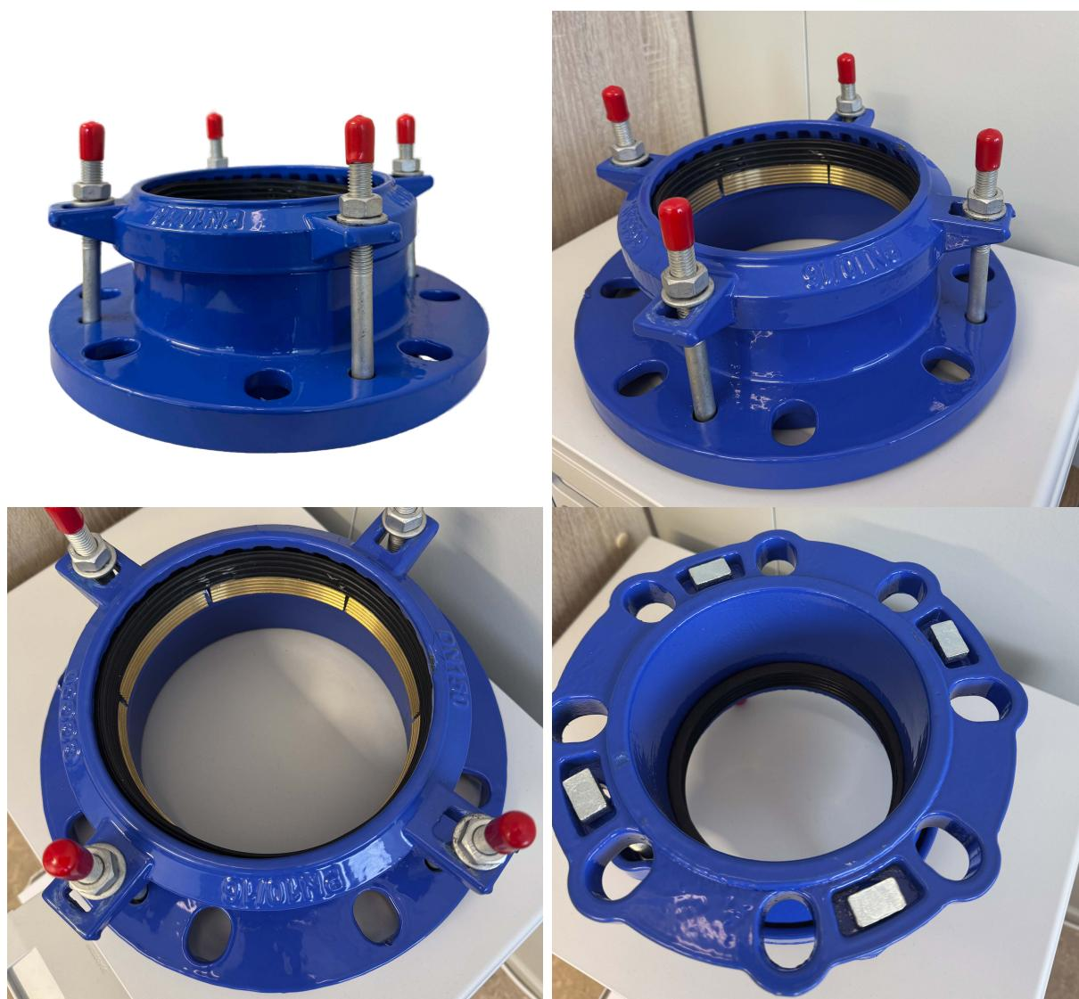
Муфта обжимная предназначена для надёжного соединения напорных труб диаметром от 109 до 133 мм с номинальным условным проходом DN 100 при рабочем давлении до 16 бар. Конструкция с внутренними анкерными зубцами и усиленным EPDM-уплотнением обеспечивает:
