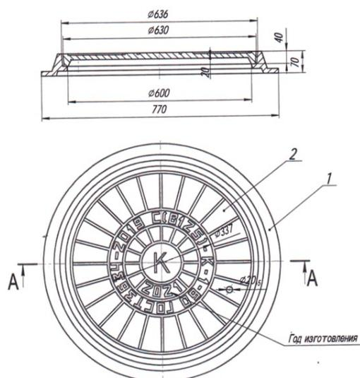
Люк средний С(В125)-1-60 h-70 производится на заводе из серого чугуна и подходит для установки на автостоянках, тротуарах и проезжей части городских парков. Номинальная нагрузка составляет 12,5 тонн. Возможно изготовление модели с запорным устройством, а также из высокопрочного чугуна. Доставка по Санкт-Петербургу и Ленинградской области.
