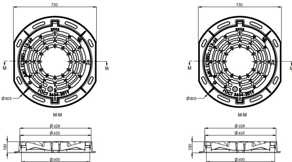
Люк чугунный дождеприемный ДМ1(С250)-1-13-60 производится на заводе из высокопрочного чугуна и подходит для установки на автостоянках, тротуарах и проезжей части дорог. Люк имеет крепление крышки к корпусу с помощью фиксатора и пружины, а также запорное устройство. Номинальная нагрузка составляет 25 тонн. Также имеется модель из [серого чугуна](#). Доставка в г. Санкт-Петербург и Ленинградскую область.
