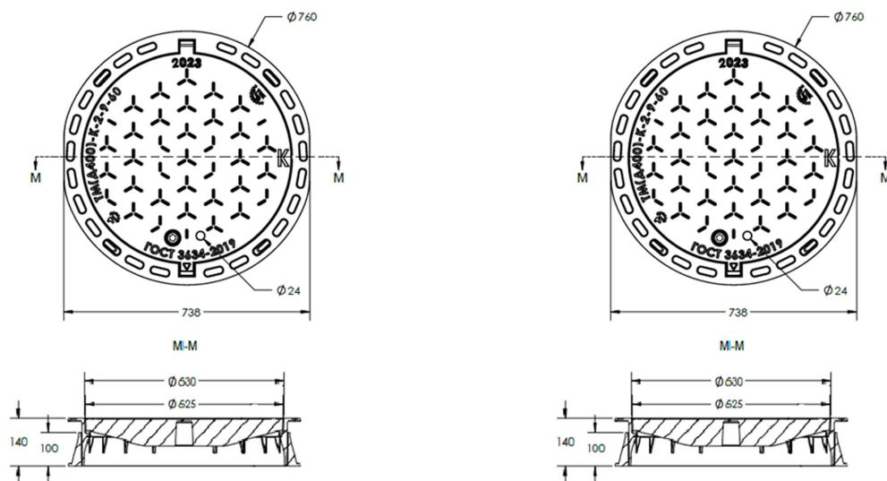
Люк чугунный тяжелый ТМ(Д400)-2-9-60 плавающего типа (имеет самонивелирующий корпус) с запорным устройством, пружиной и рем. вставкой производится на заводе из высокопрочного чугуна и подходит для установки на автомагистралях, на автостоянках и проезжей части дорог. Имеются в наличии люки с буквами «К» и «Д». Доставка в г. Санкт-Петербург и Ленинградскую область.
