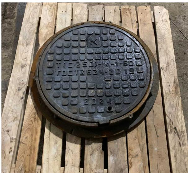
Люк чугунный тяжелый Т(С250)-1-60 производится на заводе из серого чугуна и подходит для установки на автостоянках, тротуарах и проезжей части городских парков. Несмотря на то, что модель высотой 70 мм., она полностью соответствует ГОСТ 3634-2019 и выдерживает нагрузку 25 т. Также имеется модель с запорным устройством, [модель](#) из высокопрочного чугуна и [модель](#) с размерами 850x100. Доставка в г. Санкт-Петербург и Ленинградскую область.
