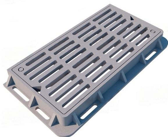
Дождеприемник чугунный ДБ2(В125)-2-36×78 производится на заводе из серого чугуна и подходит для установки на автостоянках, тротуарах и проезжей части городских парков. Номинальная нагрузка составляет 12,5 тонн. Возможно изготовление модели из высокопрочного чугуна. Доставка в г. Санкт-Петербург и Ленинградскую область.
