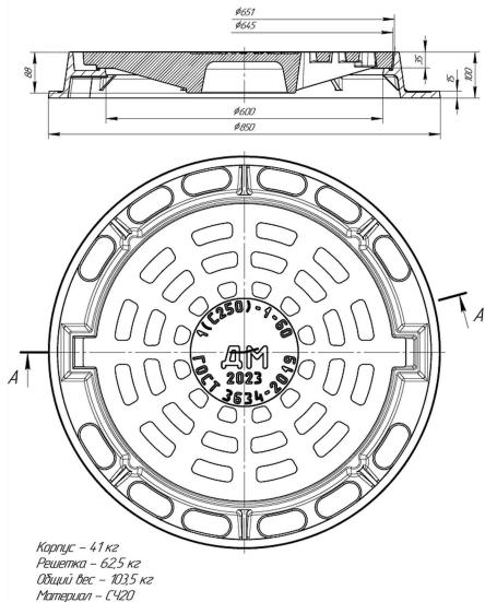
Крышка чугунная дождеприемника ДМ1(С250)-1-60 производится на заводе из серого чугуна и подходит для установки на автостоянках, тротуарах и проезжей части городских парков. Номинальная нагрузка составляет 25 тонн. Подходит для корпуса ДМ1(С250)-1-60. Доставка в г. Санкт-Петербург и Ленинградскую область.
