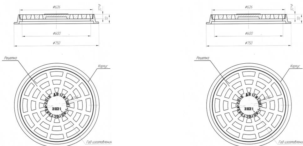
Дождеприемник чугунный ДБ1(В125)-1-60 или ДК1(В125)-1-60 производится на заводе из серого чугуна и подходит для установки на автостоянках, тротуарах и проезжей части городских парков. Номинальная нагрузка составляет 12,5 тонн. Также имеется [модель](#) из высокопрочного чугуна. Доставка в г. Санкт-Петербург и Ленинградскую область.
