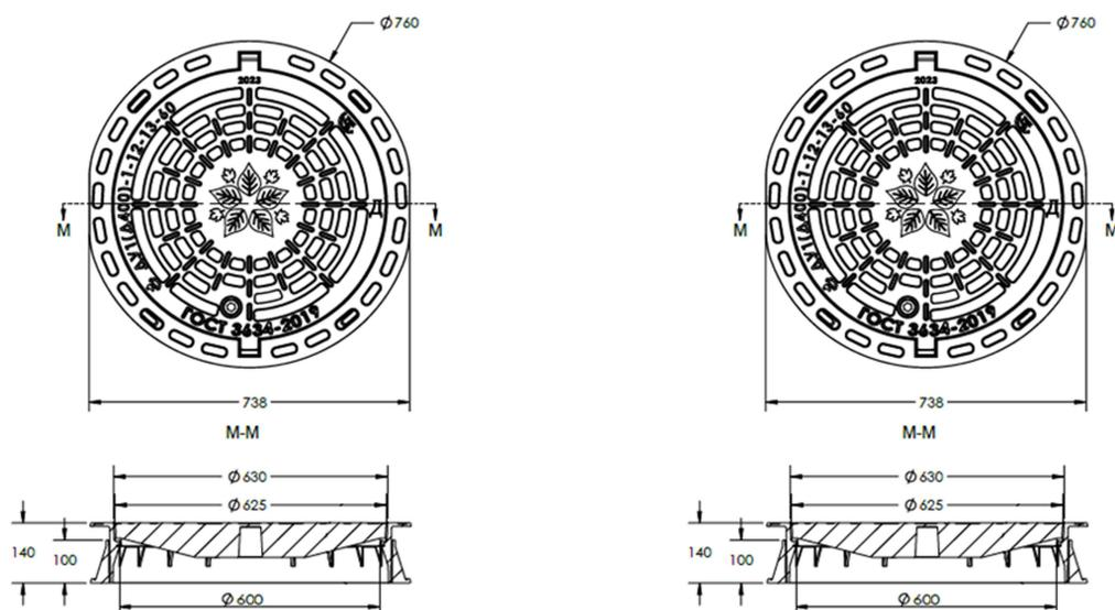
Люк чугунный дождеприемный усиленный ДУ1(Д400)-1-12-13-60 плавающего типа (имеет самонивелирующий корпус) производится на заводе из высокопрочного чугуна и подходит для установки на автомагистралях, на автостоянках и проезжей части дорог. Люк имеет крепление крышки к корпусу с помощью фиксатора и пружины, запорное устройство, ремонтную вставку и битумное антикоррозийное покрытие. Номинальная нагрузка составляет 40 тонн. Доставка в г. Санкт-Петербург и Ленинградскую область.
