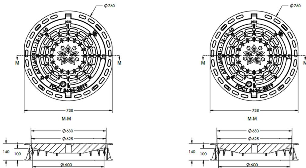
Люк чугунный дождеприемный усиленный ДУ1(Д400)-1-13-60 производится на заводе из высокопрочного чугуна и подходит для установки на автомагистралях, на автостоянках и проезжей части дорог. Люк имеет крепление крышки к корпусу с помощью фиксатора и пружины, запорное устройство, ремонтную вставку и битумное антикоррозийное покрытие. Номинальная нагрузка составляет 40 тонн. Доставка в г. Санкт-Петербург и Ленинградскую область.
