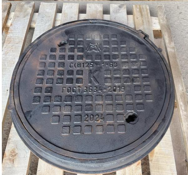
Люк средний С(В125)-1-60 h-76 производится на заводе из серого чугуна и подходит для установки на автостоянках, тротуарах и проезжей части городских парков. Номинальная нагрузка составляет 12,5 тонн. Возможно изготовление модели с запорным устройством, а также из высокопрочного чугуна. Доставка по Санкт-Петербургу и Ленинградской области.
