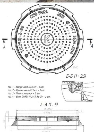
Люк чугунный тяжелый Т(С250)-2-60 с фиксатором, запорным устройством и пружиной производится на заводе из высокопрочного чугуна и подходит для установки на автостоянках, тротуарах и проезжей части городских парков. Также имеется модель из [серого чугуна](#). Имеются в наличии люки с буквами «К» и «В». Доставка в г. Санкт-Петербург и Ленинградскую область.
