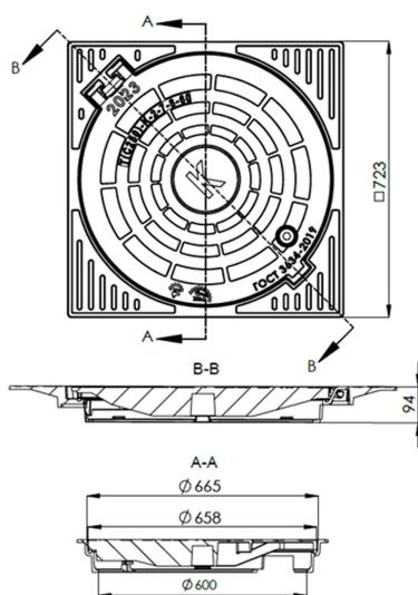
Люк чугунный тяжелый в квадратном корпусе Т(С250)-2-7-8-60 с запорным устройством производится на заводе из высокопрочного чугуна и подходит для установки на автостоянках, тротуарах и проезжей части городских парков. Люк имеет безболтовый шарнир, фиксирующие пружины и битумное антикоррозийное покрытие. Имеются в наличии люки с буквами «К» и «В». Доставка в г. Санкт-Петербург и Ленинградскую область.
