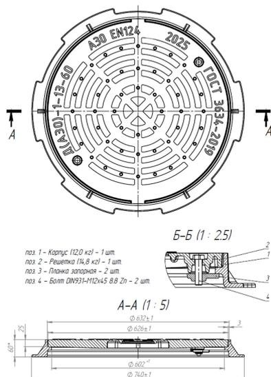
Люк чугунный дождеприемный Д(А30)-1-13-60 производится на заводе из высокопрочного чугуна и подходит для установки на автостоянках, тротуарах и проезжей части городских парков. Люк имеет запорное устройство. Номинальная нагрузка составляет 3 тонны. Доставка в г. Санкт-Петербург и Ленинградскую область.
