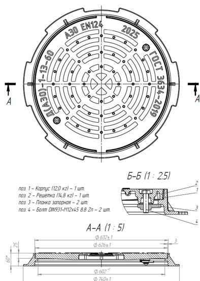
Люк чугунный дождеприемный Д(А30)-1-13-60 производится на заводе из высокопрочного чугуна и подходит для установки на автостоянках, тротуарах и проезжей части городских парков. Люк имеет крепление крышки к корпусу с помощью фиксатора и пружины, а также запорное устройство. Номинальная нагрузка составляет 3 тонны. Доставка в г. Санкт-Петербург и Ленинградскую область.
