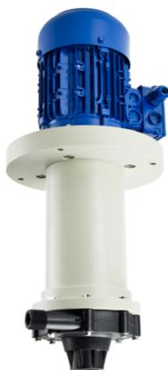
Вертикальный магнитно-сцепленный насос GemmeCotti HTM-V из полипропилена (PP) или PVDF – это специализированное решение для безопасной и эффективной перекачки агрессивных жидкостей непосредственно из емкостей, резервуаров и картеров. Его компактная вертикальная конструкция с магнитным приводом спроектирована для погружного монтажа, обеспечивая полную герметизацию и надежную работу «на откачку» без риска протечек.
