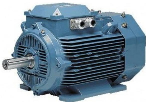
**Искробезопасный двигатель АВВ М3НР 355 SMA EEx nA** — это высокомощное и надежное решение для безопасной эксплуатации во взрывоопасных зонах класса 2. Данная модель сочетает в себе тип защиты «искробезопасный» (EEx nA), который гарантирует отсутствие искрения, дуги или опасного перегрева в нормальном режиме работы, с исключительной энергоэффективностью и мощностью **315 кВт**.
